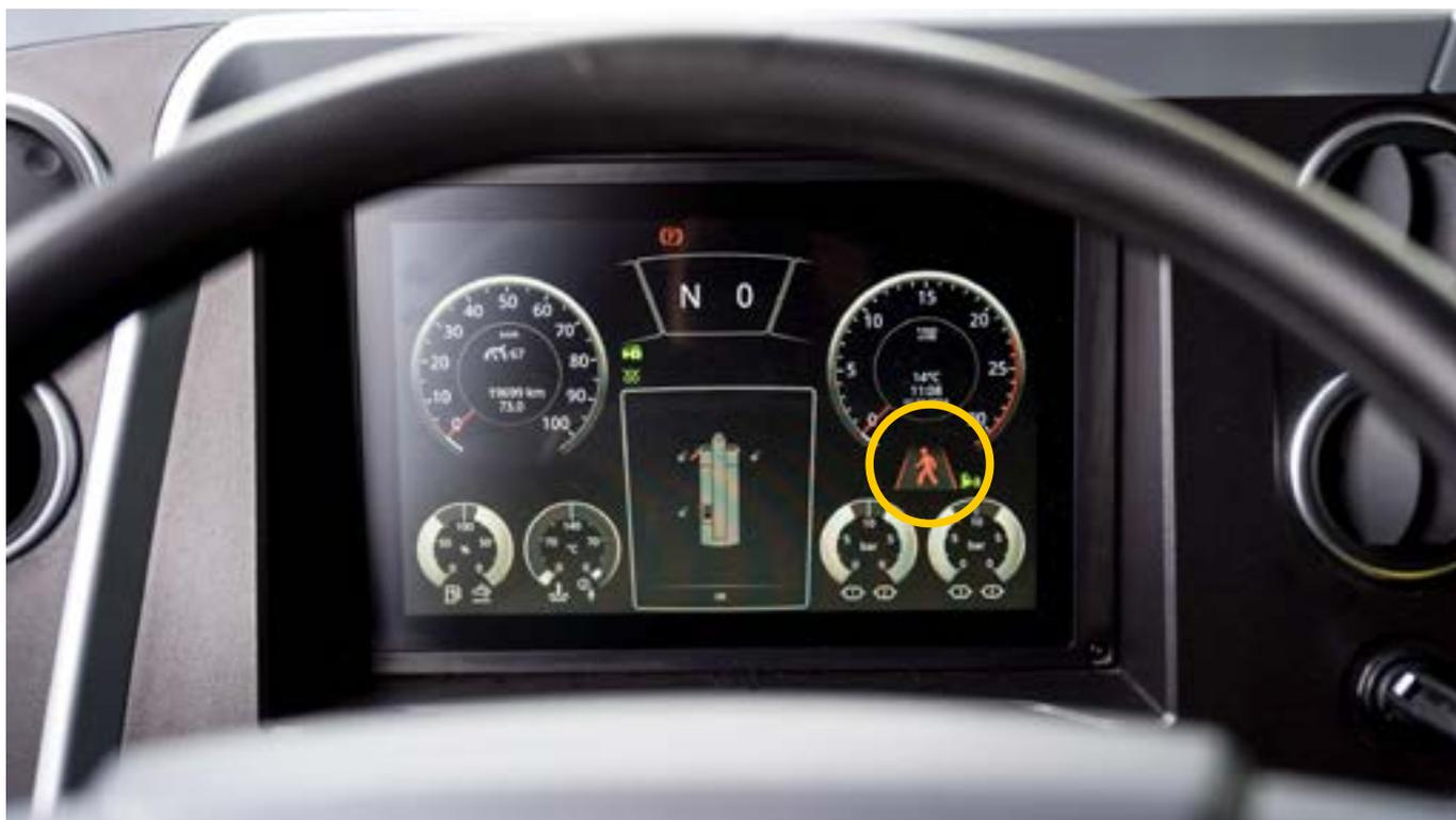
Le système anticollision avertit le conducteur de la grue par un signal visuel et sonore dès que quelqu'un s'approche de la grue.
