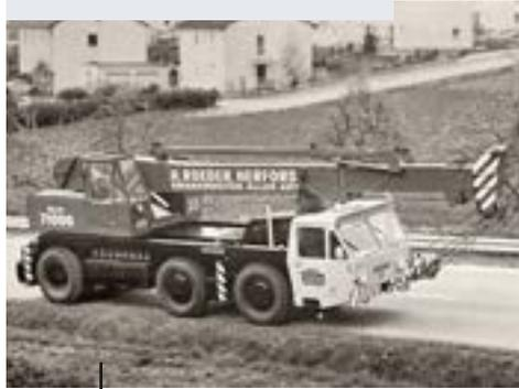
Le best-seller d'Ehingen : la grue AUK 40T-60 avec sa flèche télescopique de 24 mètres et sa transmission entièrement hydraulique.
