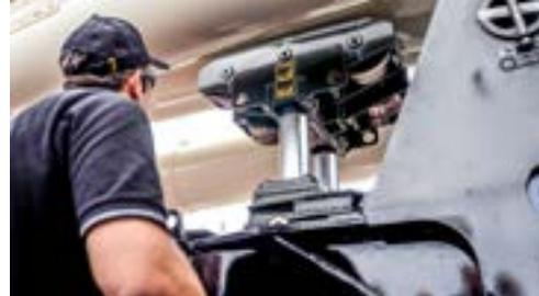
Un dispositif est monté à l'arrière de la grue pour soulever la flèche.
