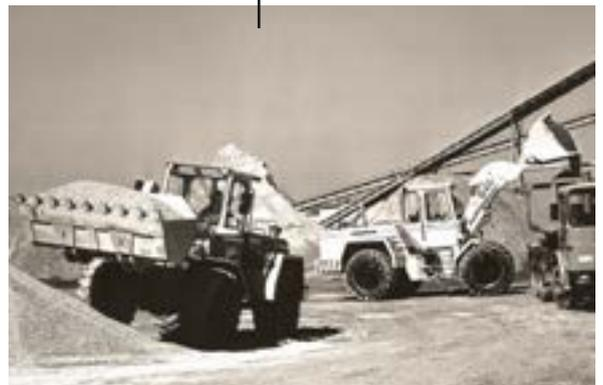
Les premières chargeuses sur pneus L 531 et L 541 sont lancées sur le marché. Leur transmission hydrostatique réduit la consommation de carburant. La translation progressive est idéale pour les véhicules utilitaires et les freins ne subissent pratiquement pas d'usure.
