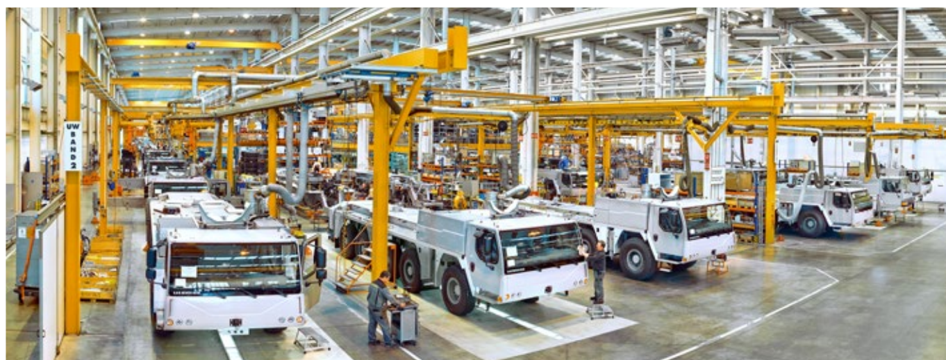
Сборка мобильных кранов на заводе Liebherr в г. Эхинген, Германия
