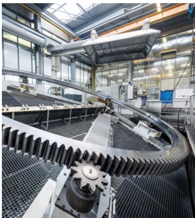
Индукционная закалка опорно-поворотных устройств
