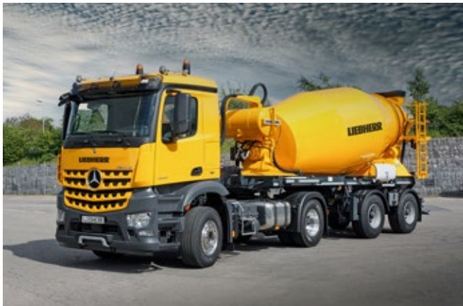
Автобетоносмеситель НТМ 1004 ZA/38 имеет общий вес 38 т
