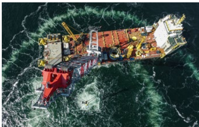
При максимальной грузоподъемности 1250 тонн морской кран BOS 35000 предназначен для перевалки тяжелых и габаритных грузов
