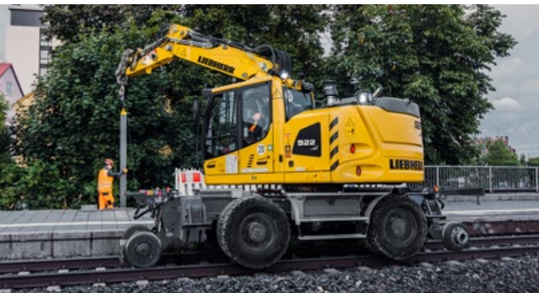
A 922 Rail Litronic на монтаже шумозащитного экрана
