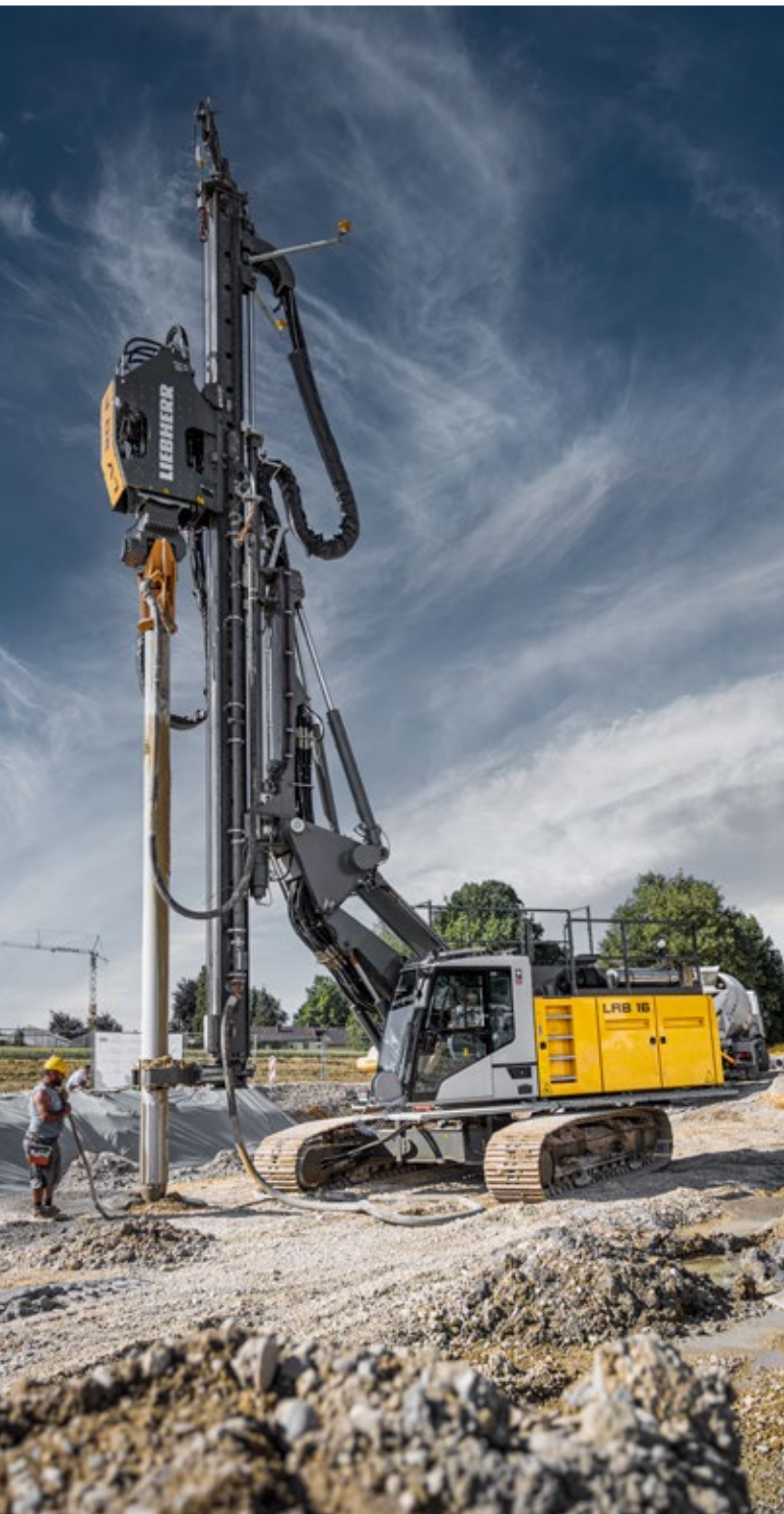
Сваебойная и буровая установка LRB 16 устанавливает сваи-оболочки
