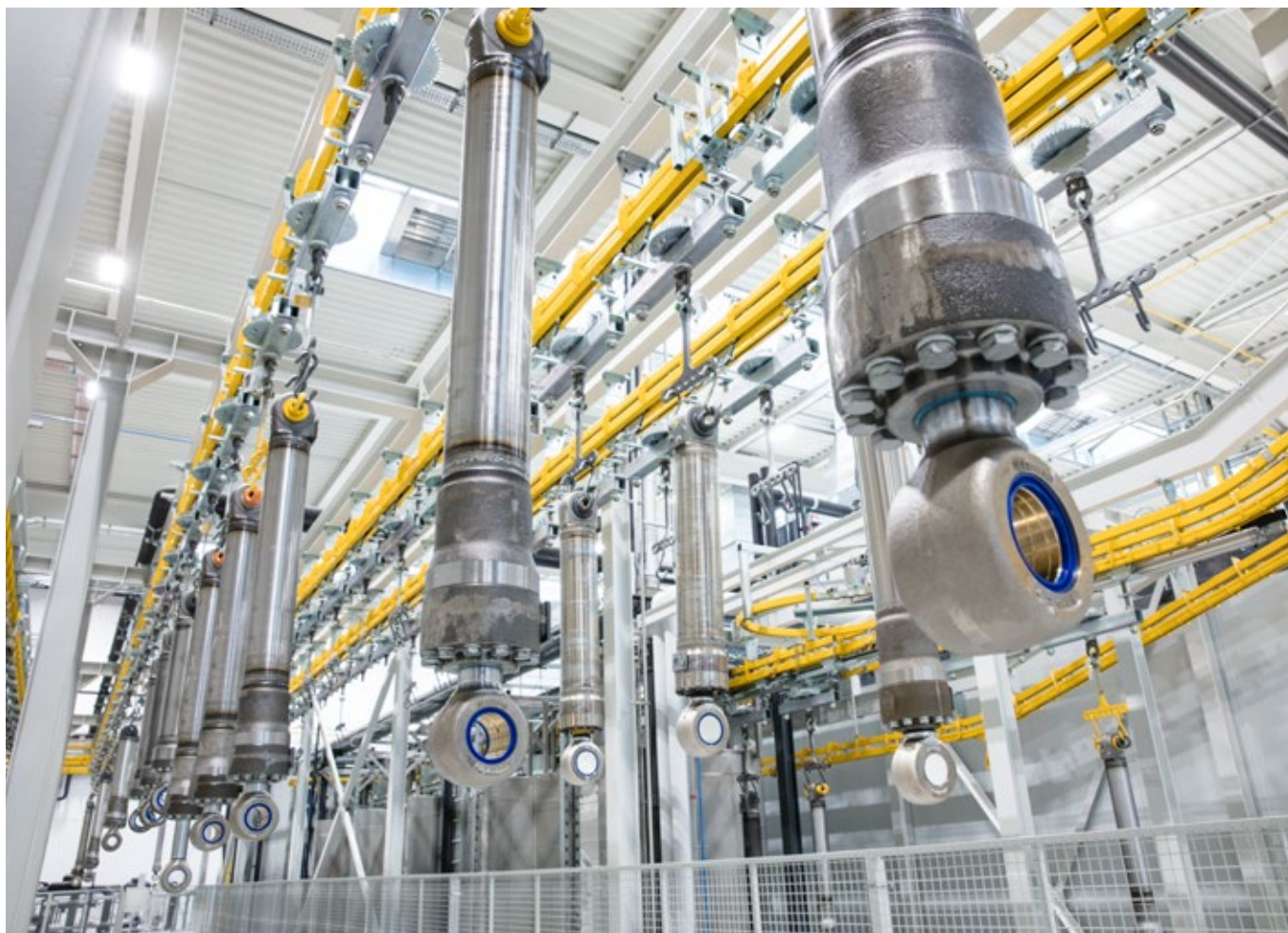
Роботизированная линия покраски в серийном производстве гидроцилиндров
