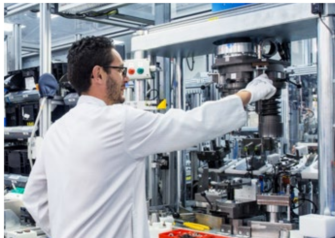
Монтаж топливных систем Common-Rail в чистом помещении
