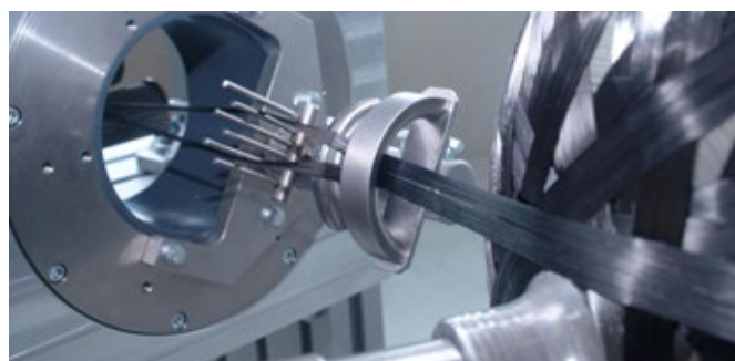
Производство из углепластика на собственных намоточных станках
