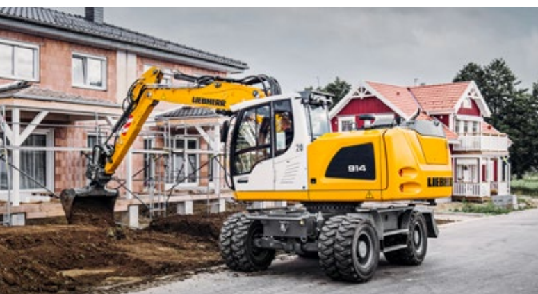
A 914 Litronic с быстросменной системой LIKUFIX® и поворотным ковшом выполняет работы по озеленению и благоустройству
