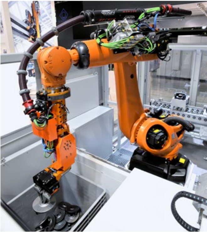
Bin Picking: робот для захвата деталей из россыпи
