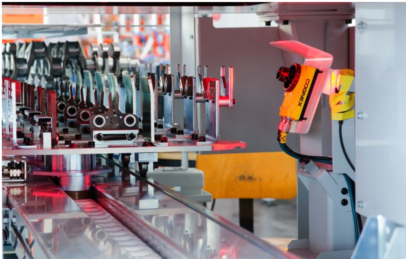
Полимерный цепной транспортер (ККВ) в качестве системы транспортировки, например, коленвалов
