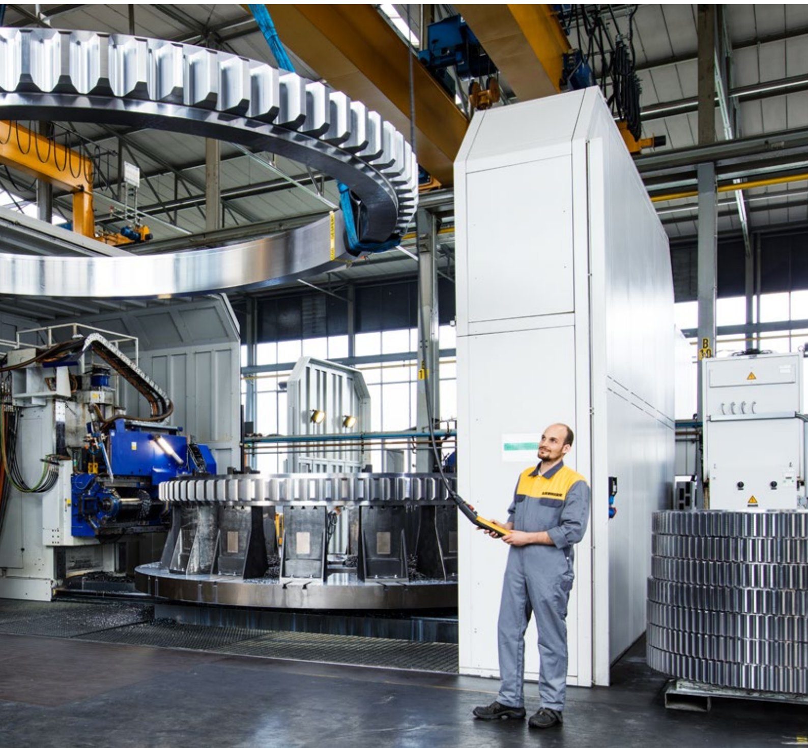
Точная обработка методами шлифования и полирования
