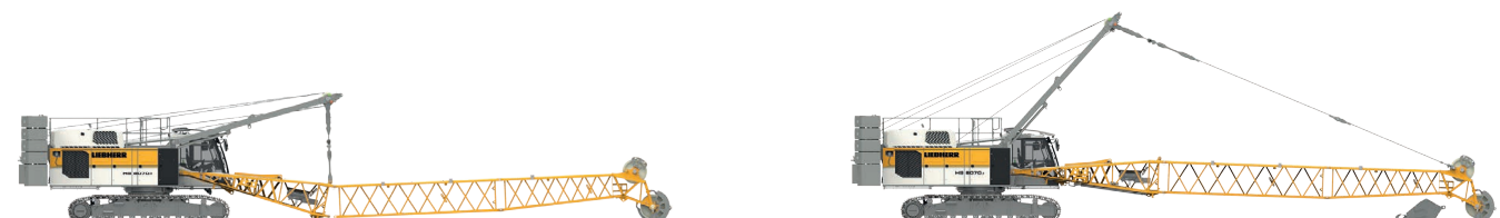
Anbau des Auslegers und Einziehen der Hubseile
