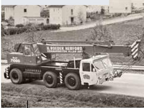
Bestseller aus Ehingen (Deutschland): Der AUK 40T-60 mit seinem 24 Meter langen Teleskopausleger und vollhydraulischen Kranantrieb.
