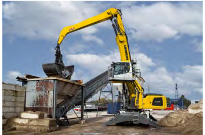
Alimentation d'une centrale à béton avec la LH 40 M Industry Litronic
