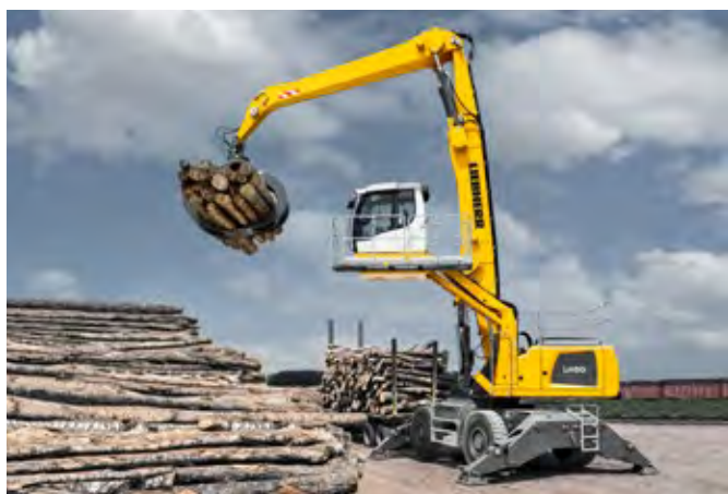
La LH 50 M Industry Litronic avec remorque pour la manutention de rondins de bois
