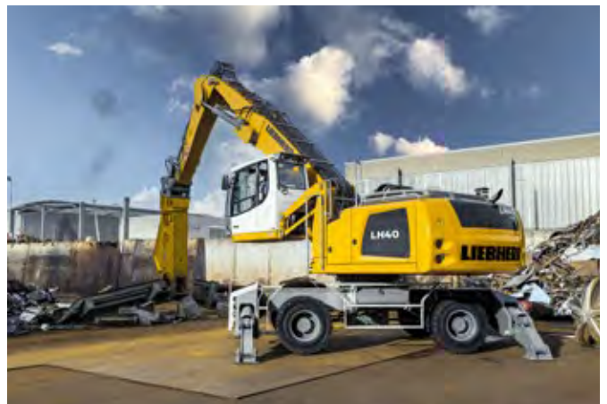
La LH 40 M Industry Litronic pour le désassemblage de poutres métalliques avec une cisaille ferraille
