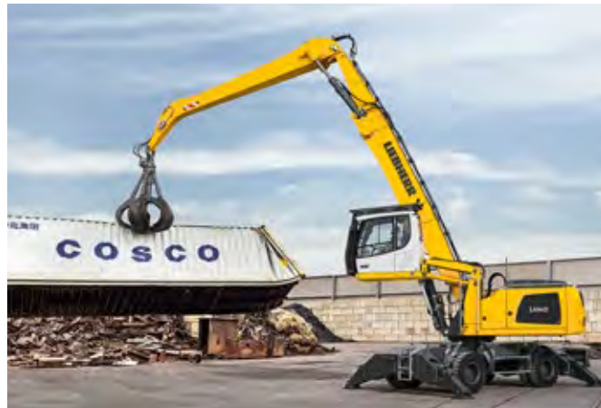
Désassemblage de containers avec la LH 40 M Industry Litronic
