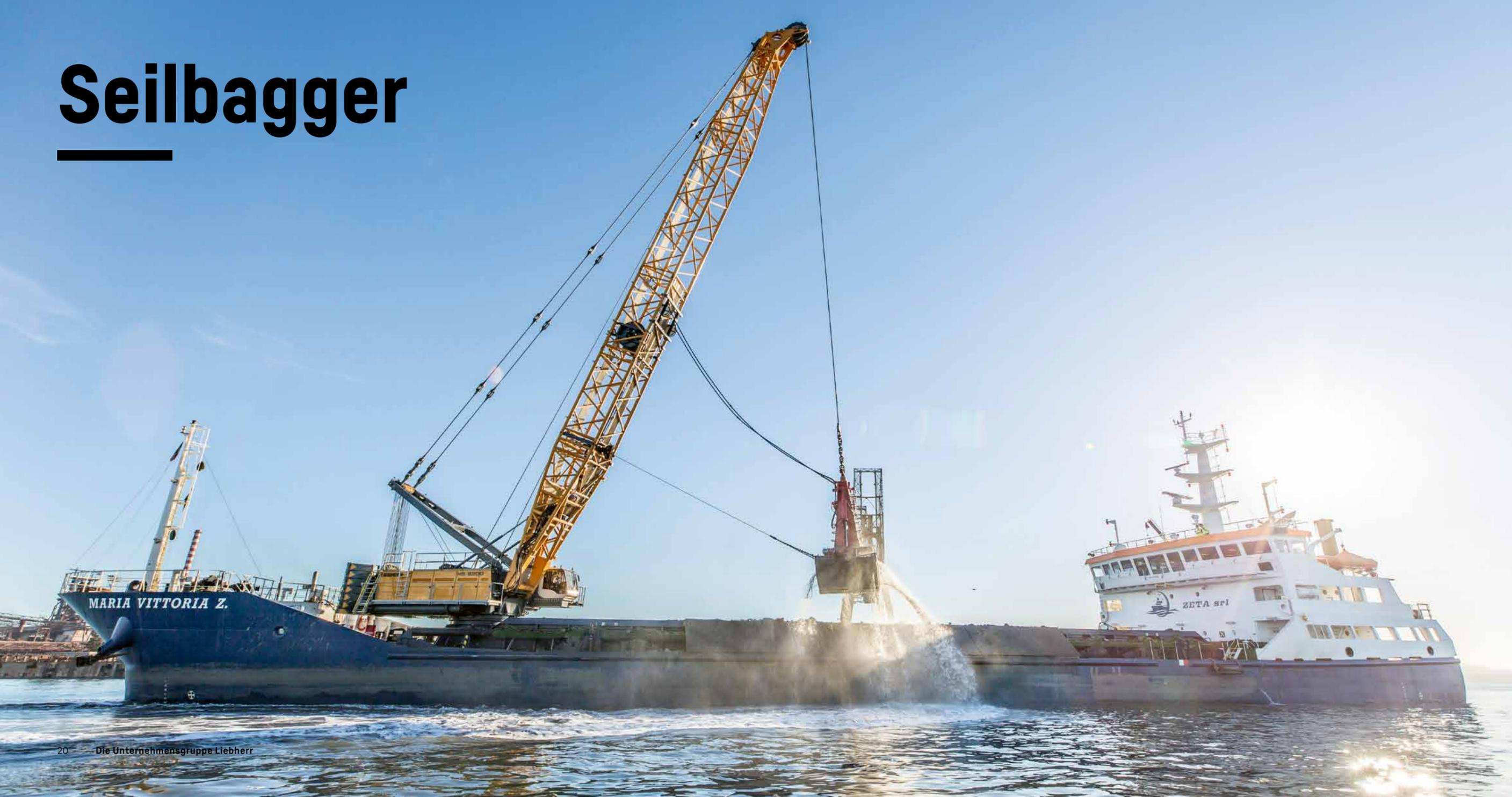
Ein seit der jüngeren Vergangenheit immer wichtiger werdendes Einsatzgebiet der Liebherr-Seilbagger ist das Nassbaggern. Bei diesem auch als Dredging bekannten Verfahren sind die Geräte entweder auf einem Schiff oder Ponton befestigt bzw. arbeiten vom Ufer oder von Hafenanlagen aus.
